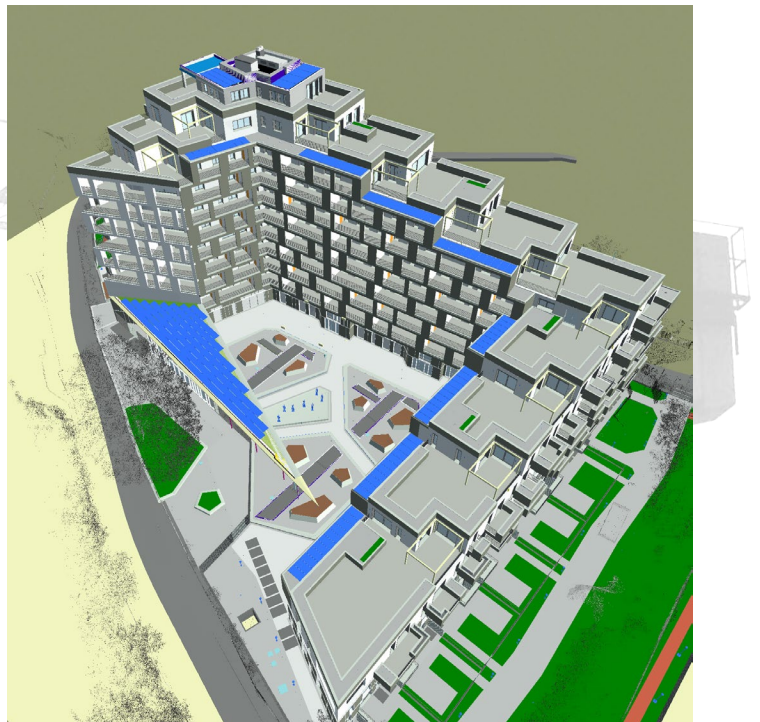
Vista Revizto- pannelli fotovoltaici in copertura
